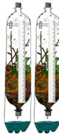
Modelo de las columnas de descomposición
