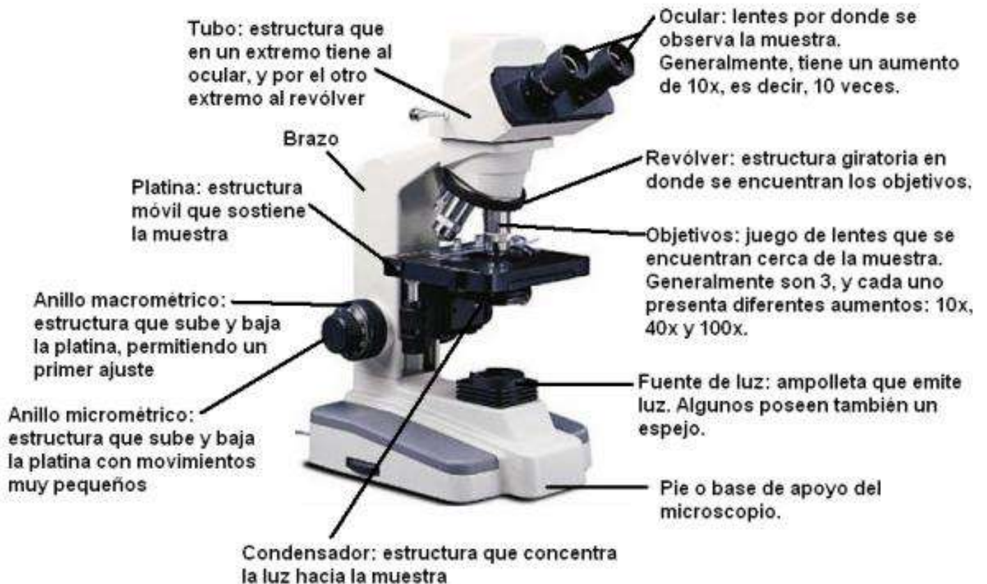
Diagrama 3: Parte y función del microscopio
