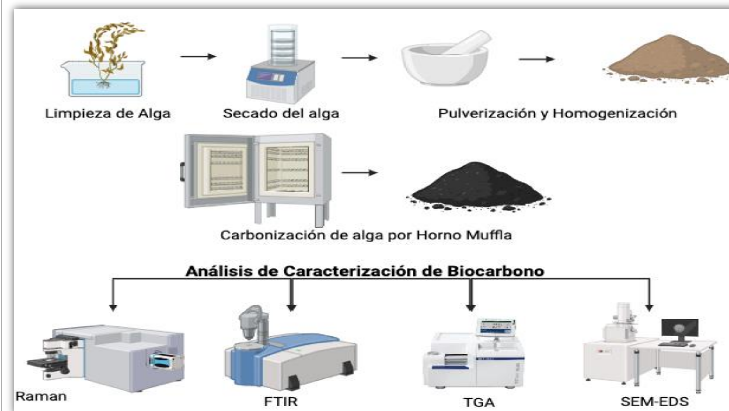
Figura 3: Proceso de carbonización y caracterización de biocarbono de alga
